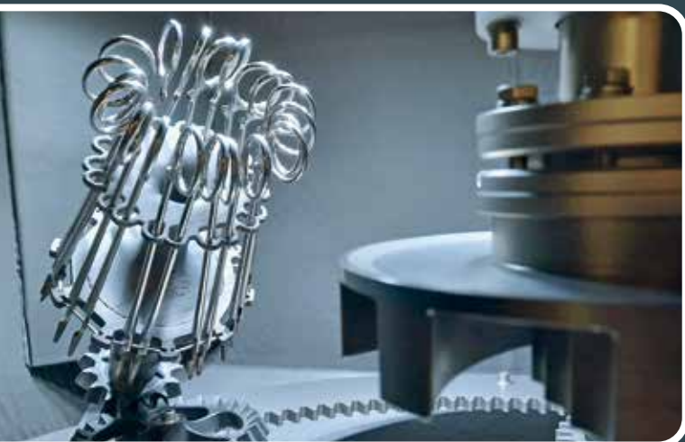
Obrobky v tryskacím systému BMF TWISTER na 3D vytištěném nosiči obrobků
