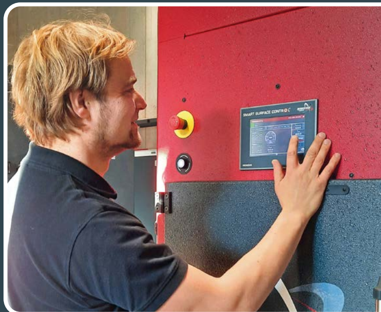
Os parâmetros de granalhagem desejados são introduzidos de forma rápida e fácil num painel tátil
