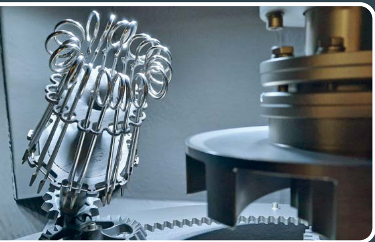
Peças de trabalho num sistema de granalhagem BMF TWISTER num porta-peças impresso em 3D
